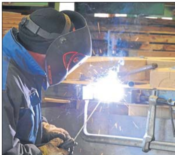
Andre Krietemeier schweißt den Eisenring an das Holzrad. Er soll später als Schutz dienen.
