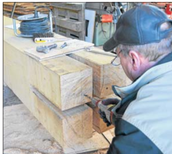
Tischler Peter Meißner arbeitet an der Lagerwelle, auf der das Mühlrad später befestigt werden soll.
