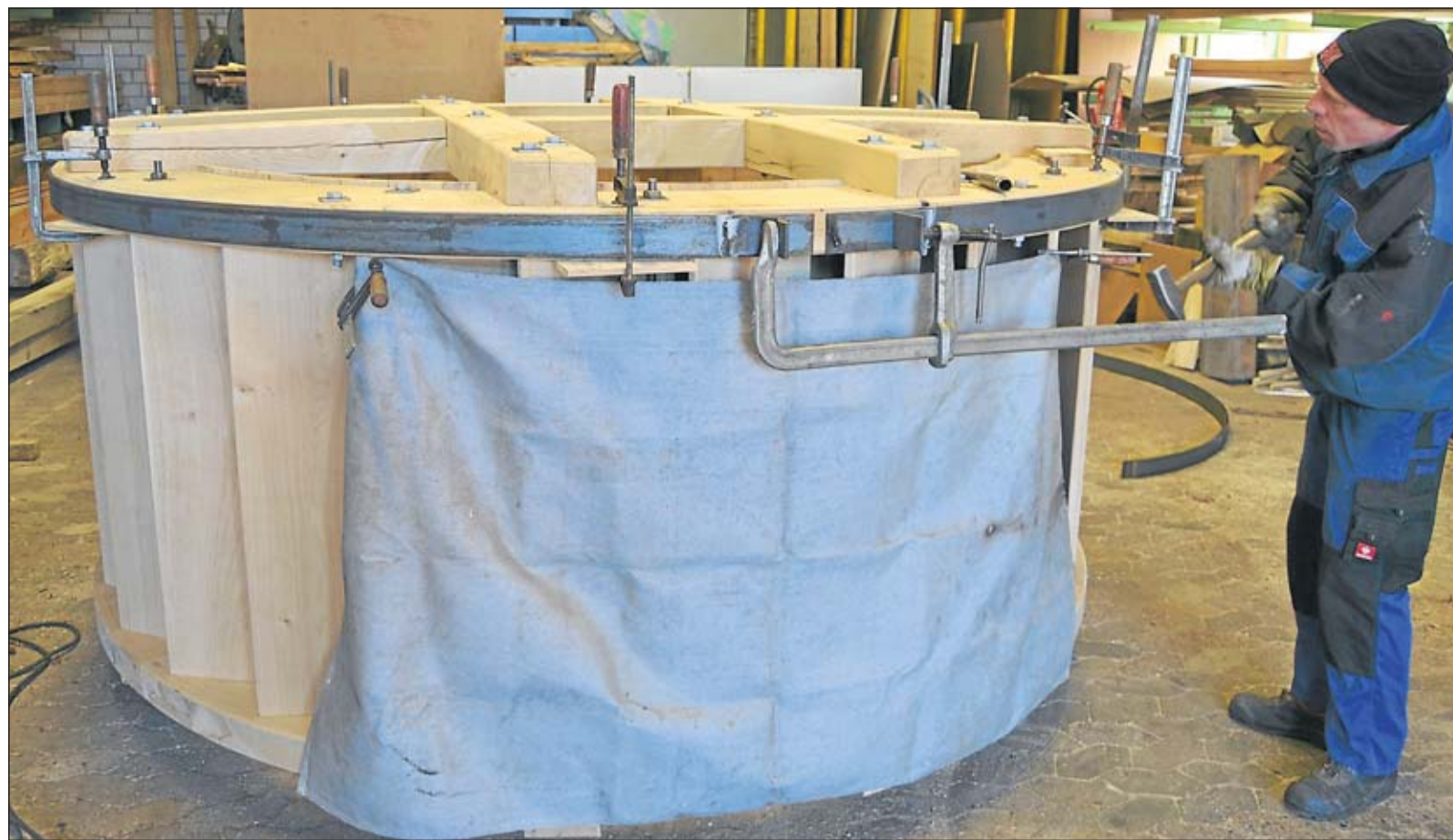
Schlosser Andre Krietemeier spannt auf dem Mühlenbauhof den Eisenring um das Mühlenrad mit einem Durchmesser von 2,60 Metern. Mit Schraubzwingen wird der Ring immer fester an das Holz gebracht, bis es schließlich fest geschweißt wird. Fotos: Stefan Watermann
